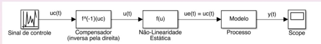
**Figura:** Compensação da não-linearidade estática  $z = f(x)$  com  $f: A \rightarrow B$  sobrejetiva, onde: Planta = Não-Linearidade Estática + Processo,  $u_c(t)$  é o sinal de controle,  $u(t)$  é o sinal do atuador e  $u_e(t)$  é a **entrada efetiva** no processo. Aqui, assumimos que  $u_c(t) \in B$ , para todo  $t \geq 0$ . **Importante:** Quando consideramos saturação no atuador, então: Planta = Bloco Saturação + Não-Linearidade Estática + Processo.
